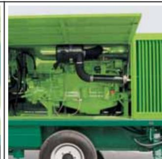
Accionamiento hidrostático de la bomba de hormigón con bombas (unidades de bombas de émbolos axiales Hydromatik) que cuentan con potencia regulable y regulación del caudal. Circuito de refrigeración de hidráulica separado con radiador de aceite accionado por vía hidráulica.
