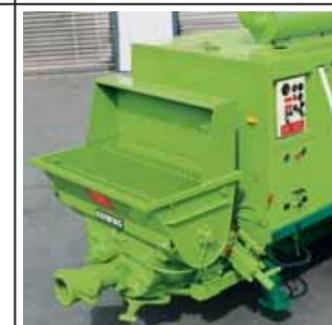
△ Corredera Rock concebida para el empleo bajo condiciones extremas, con alojamiento axial reforzado del árbol de giro y cilindro de giro adicional para la inversión de la corredera. Se puede aumentar el contenido de la tolva de relleno (mostrada todavía sin borde de caucho) por medio de suplementos de goma y poner según los requerimientos del cliente. En el revestimiento está integrado un bastidor portante. Está equipado con orejas de transporte soldadas.
