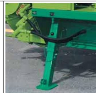
Posición estable por el apoyo mecánico autoestabilizante en A, preparado para la versión hidráulica (equipamiento especial).
