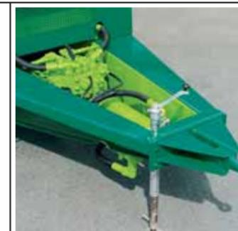
◁ Instalada seguramente entre los largueros resistentes del bastidor básico soldado: el grupo de bombas de hormigón. El bloque de mando, sin embargo, ofrece acceso fácil (p. ej. para conmutar al lado del émbolo o al lado del vástago del émbolo).
