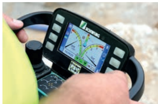
Manejo intuitivo del sistema de asistencia Diractive a través del mando por radio SC 50
