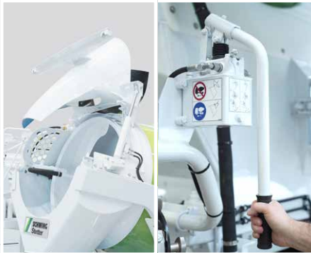
Tolva de carga giratoria hidráulicamente (facilita la limpieza a alta presión del tambor mezclador)
