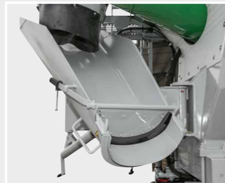
Canaleta giratoria con sistema de bloqueo
